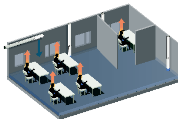
Exempel placering av TubusWall i ett rum
