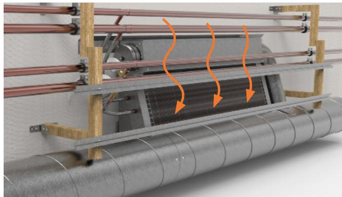
Se till att serviceluckan är åtkomlig efter färdigställt montage samt att induktionsluften får fritt utrymme till batteriet.
